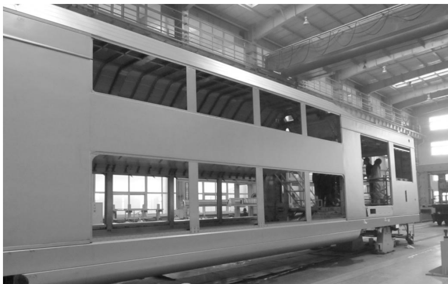
Рис. 1. Вагон швидкісного потягу після зварювання каркасної частини з обшивкою
